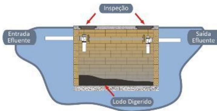
Figura 6 - Tanque séptico
